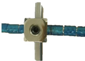
FIGURA 13. Barra transversal y llave con la que se regula su posición
