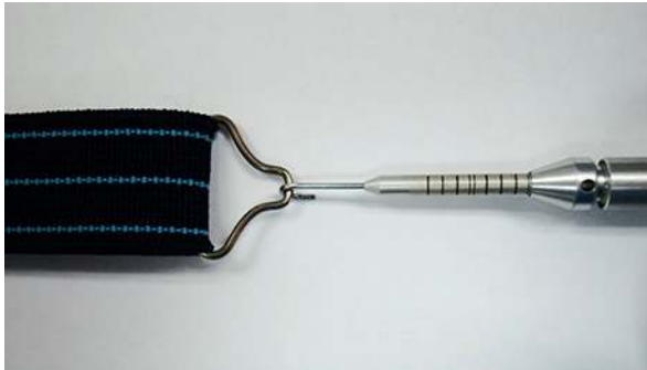
FIGURA 16. Forma de medir la fuerza con el dinamómetro
